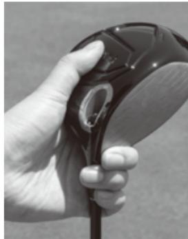
②調角ユニットスクリューの凹に専用トルクレンチに装着した調角ホルダーのツメを合わせ、スクリューを反時計回りに1~2回転させ緩めてください。
